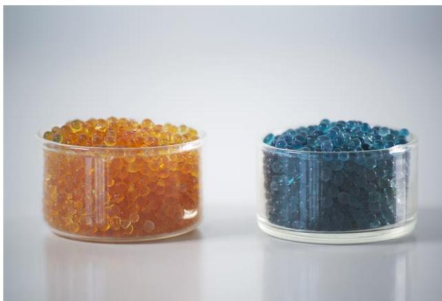
A sílica-gel standard que disponibilizamos tem uma forma esférica, com dimensões entre 2-5 mm, e indicador de saturação (i.e., muda de cor quando atinge o limite de adsorção de humidade). Os indicadores utilizados não incluem sais de cobalto (potencialmente cancerígenos), sendo possível adquirir na versão *laranja/verde* (indicador orgânico) ou *laranja/pérola* (indicador à base de sais ferrosos).
